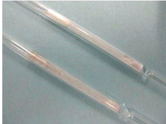
<그림 15> 50번 이상 시료분석하기 전과 후의 CIS GC주입구 라이너 (위: new, 아래: >50번 분석)
