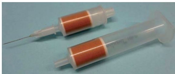
<그림 2> 위: GERSTEL MPS용 SPE카트리저, 아래: 일반적인 SPE카트리저
