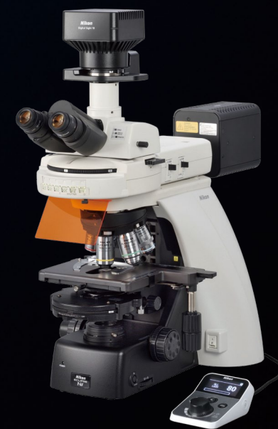
에피형광 큐브 터렛, 에피형광 부착물, 전동식 DIC 6중 노즈피스, 형광 LED 조명 Digital Sight 카메라 Digital Sight 10이 포함된 수동 현미경 Ni-L 구성
