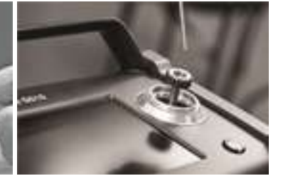
주입구에 PSI-Probe 장착후, GC/MS 분석을 시작합니다.
