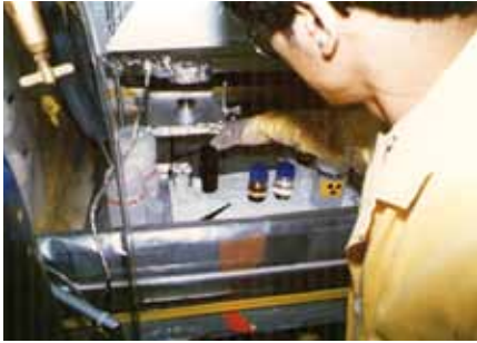
독일 문헌 공과대학 방사화학연구소 실험실에서 알파방출 핵종인 ^{238}\text{Pu} 에 의한 \text{NpO}_2^{2+} 환원 반응을 실험 중인 필자
