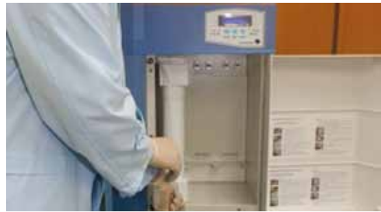
⑧ Membrane pack 필터 하단의 연결튜브를 장착합니다(이때 딸깍 소리가 나면 정상적으로 연결된 것입니다). R.O. Membrane pack의 경우 필터 하단에 장착되어 있는 원터치 피팅 클립을 "딸깍" 소리가 나도록 아래로 눌러 외부로 연결된 피팅을 제거하여 주십시오.
