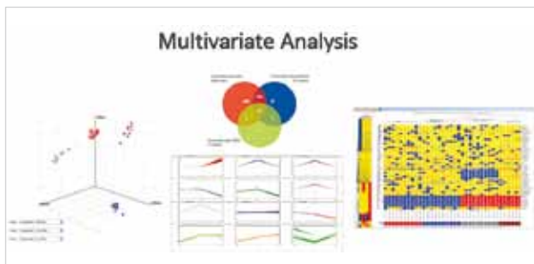
(그림 6) MPP는 질량분석데이터에 통계기법을 보다 쉽게 적용시킬 수 있도록 고안된 소프트웨어이다. GC/MS(/MS), LC/MS(/MS)로 분석한 데이터를 별도의 프로세싱 없이 곧바로 MPP에 적용하여 t-테스트, ANOVA 분석, 주성분 분석, 군집분석, 판별분석 등 다양한 통계결과를 도출할 수 있다. 이들 결과를 도출하는 과정 역시 기존의 통계 프로그램과는 다르게, 적용하고자 하는 기법을 위한 개별적인 프로그래밍 필요 없이 단지 클릭만으로 모든 과정을 진행할 수 있어 통계 전문가가 아니더라도 좋은 결과를 획득할 수 있다.
