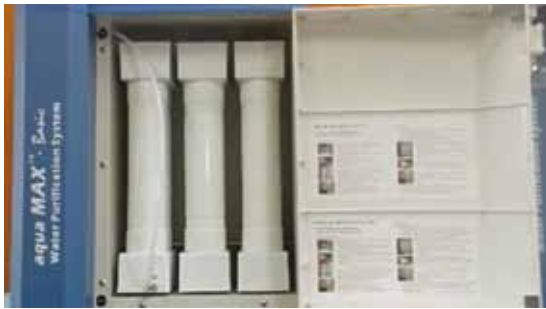
⑦ 순서는 왼쪽부터 R.O. Membrane pack, Pre pack, Post pack 순으로 연결합니다.
