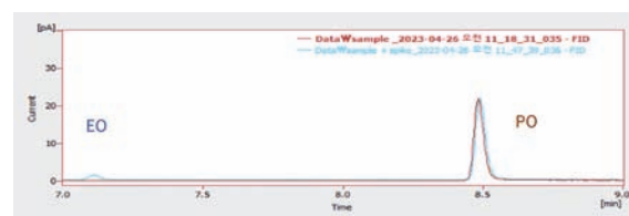
Fig 4. Chromatogram of Sample (A : 의료용 거즈, B : 보건용 마스크)
