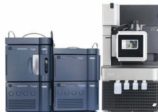
그림 1. 사용된 LC-MS/MS 시스템 Waters ACQUITY UPLC I-Class PLUS SM-FL BSM/BSM 병렬 컬럼 재생 시스템(Single Elution Pumps, p/n: 176005409). 분석물질 검출 및 정량에는 Waters Xevo™ TQ-S Micro Tandem Mass Spectrometer를 사용하고 양이온 전기분무 이온화(positive electrospray ionization) 모드 및 다중 반응 모니터링(MRM) 방식으로 데이터를 수집했다.
