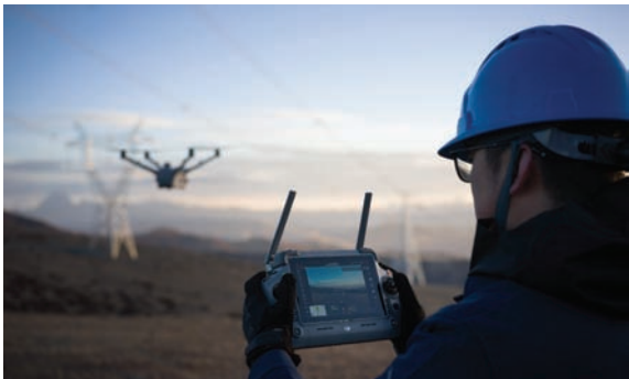
[그림 3] DJI Dock 3을 이용한 인프라 시설 점검
